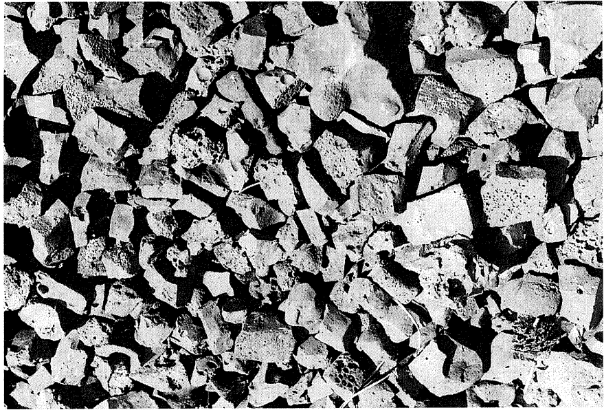
Typische kleinstückige 5 - 30 m/m dicke Plattenschlacke aus dem Oberhalbstein.
