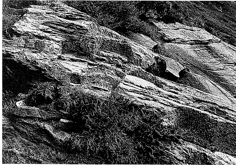
Abb. 4.4: Zylindrische Abbauspuren am Vorkommen von Cima di Rierna/Verzasca (Lok. 2): Auch die kleinsten Vorkommen wurden ausgebeutet.
