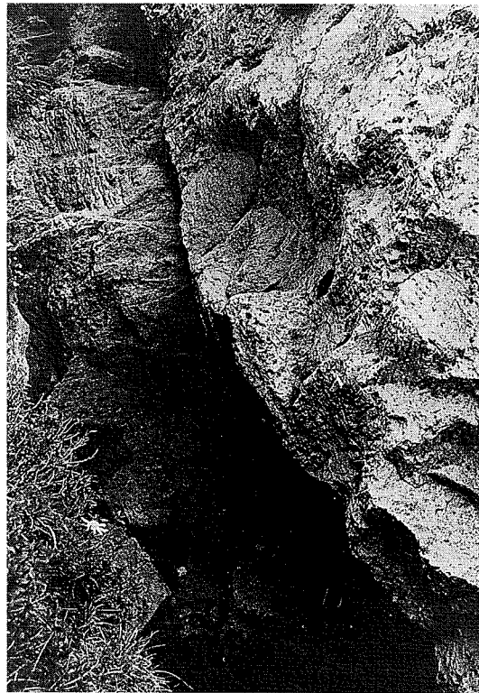
Abb. 4.5: Abbauspuren am Rand der Linse von Guglia (Lok. 4), Bildausschnitt entspricht ca. 1.5 m. Die schmale schachtartige Abbaustelle ergab sich aus der schalenartigen Ausbildung der Lagerstätte (cf. Abb. 4.6).
