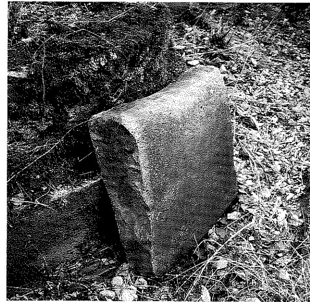
Abb. 18: Vertikal gestellter Schleppstein im stark abgenutzten Bodenstein einer Arrastramühle. Foto Hans-Peter Bärtschi, Winterthur, 1988.
