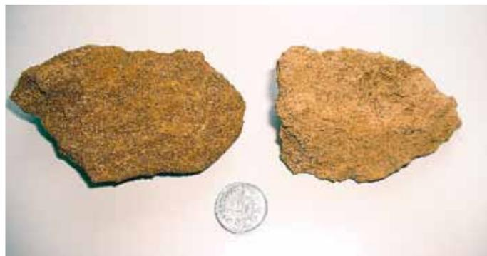
Fig. 2 : Aspect des faciès ferrugineux (à gauche) et calcaire (à droite) de la «Limonite du Valanginien» de Oye-et-Pallet.
